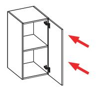
Posicionar a porta paralelamente com a lateral e fixar as dobradiças utilizando os parafusos 4x14 *H*
