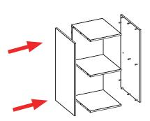
Encaixar as peças nas laterais pré montadas no sentido indicado pela imagem
